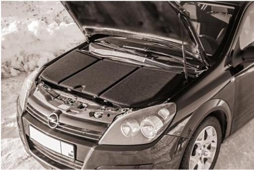
STP HeatShield es el aislador acústico del capó y cubierta del capó (diseñado para proteger el motor del vehículo del calor a largo plazo, y para la reducción el ruido del motor. El producto puede ser explotado en cualquier temporada.
