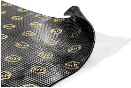
Material de STP Mass'a Bass'a tiene estructura de múltiples capas, que consiste en una capa de revestimiento, una placa a base de betón y una capa de instalación adhesivo cubierto con película de liberación. Una capa de revestimiento es hoja de aluminio.
