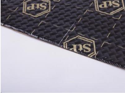
STP BLACK GOLD se utiliza como revestimiento amortiguador de vibraciones en vehículos, maquinaria agrícola y otros objetos, los cuales deben cumplir requisitos particulares de reducción efectiva de ruidos y vibraciones. El material está diseñado para ser utilizado a temperaturas de -45 a 100 ° C; El material puede sobrevivir a la acción a corto plazo de la temperatura hasta 190 ° C.
